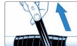
2. ... das Band auf seine doppelte Länge dehnen, fest um die Oberfläche wickeln ...
